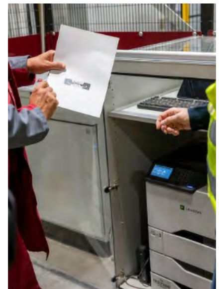
Lexmark RFID-Drucker druckt Palettenfahnen und codiert den RFID-Chip in einem Arbeitsgang.
