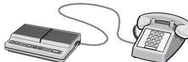
**5** Conecte un tercer cable telefónico del contestador automático al puerto EXT
