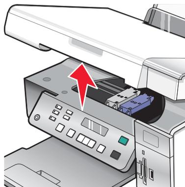
**12** Presione hacia abajo las palancas del carro del cartucho para levantar las tapas.
